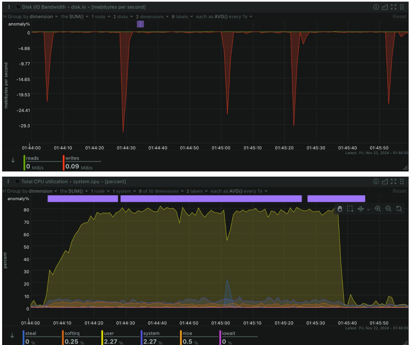
Рисунок 18 – Результаты замеров нагрузки при 1000 параллельных потоках
