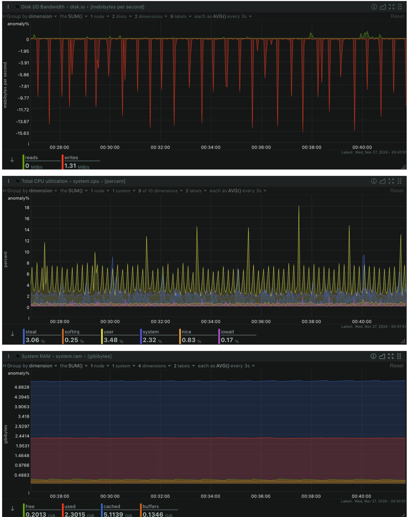
Рисунок 14 - Графики замера нагрузки блокчейн-сети при генерации пустых блоков на центральный процессор, жесткий диск и оперативную память (количество пакетов, загрузка сети, загрузка жесткого диска, загрузка процессора, загрузка оперативной памяти)
